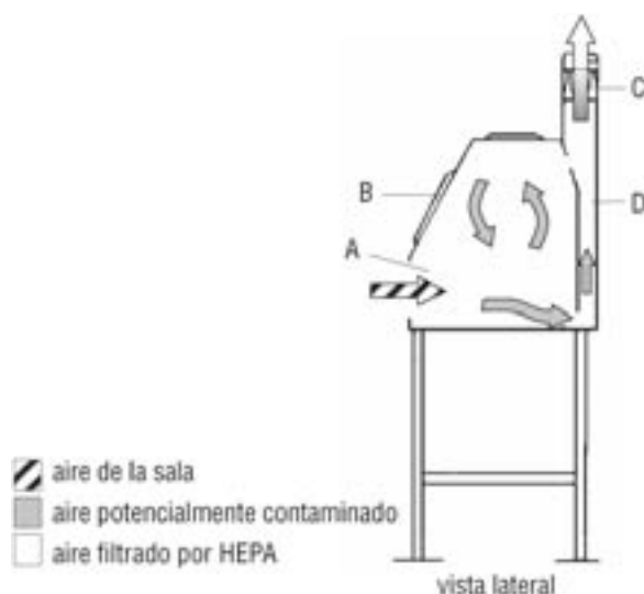
Figura 6. Esquema de una cámara de seguridad biológica de clase I.
